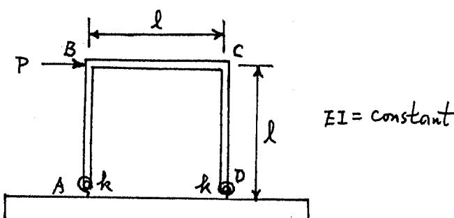
2. 如圖所示之構架，構件之斷面如圖示。假設材料之彈性模數  $E = 2 \times 10^5 \text{ kg/cm}^2$ 。如 D 點向下沈陷 2cm，
