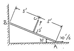
5. 一均勻桿重 W,於A點被栓住,於B點被金屬線拉住。試求線斷之瞬間及桿已轉動45°的時候作用於點A之力為若干?(20%)
