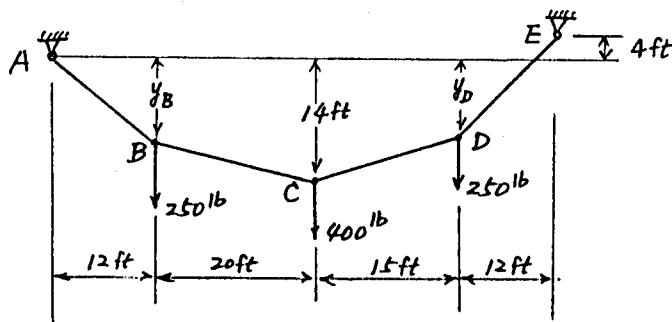
2. 試求二索張力及 A 真 (ball-and-socket) 之反力。
