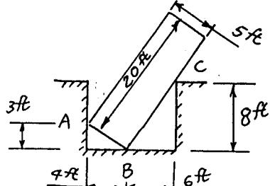
(二) 如圖所示，擋水牆承受水壓，水重 $\rho_w = 1.02 \text{ Mg/m}^3$ ，牆體材料重 $\rho_c = 2.45 \text{ Mg/m}^3$ 。分別計算牆體所承受之水壓，及牆體施予基礎之作用力。
