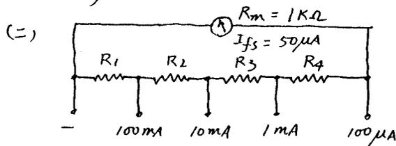
如左圖的 Ayrton Shunt 電路,
