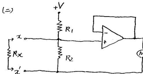
如左圖的電子式 Ohmmeter circuit, 若其 meter movement  $M$  的  $I_{fs} = 50\mu A$ , 且內電阻  $R_M = 2k\Omega$ , 試求出  $R_1, R_2$  及  $V$  的值. (假設  $R_1 = R_2$ , 且 Midscale Reading 是  $100\Omega$ ) (15%)
