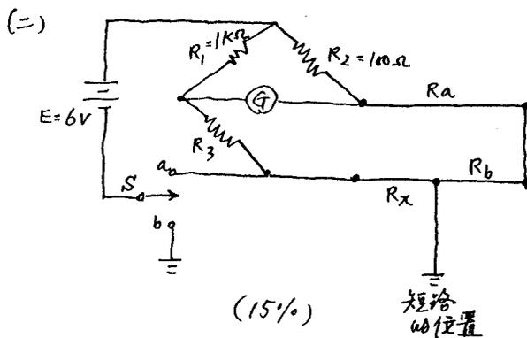
如左圖的 Varley loop 接線, 若開關  $S$  切到  $a$  的位置時, 電橋平衡的條件是  $R_1 = 1000\Omega, R_2 = 100\Omega, R_3 = 53\Omega$ . 當  $S$  切到  $b$  的位置時, 電橋平衡的條件變成  $R_1 = 1000\Omega, R_2 = 100\Omega, R_3 = 52.9\Omega$ . 若被發生短路現象的導線之電阻為  $0.015\Omega/m$ , 則請問短路的位置離電橋位置有多遠?
