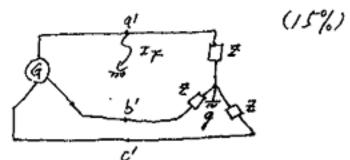
若吞电机中性关不接地,且故障前的 =120 前故障电流节
